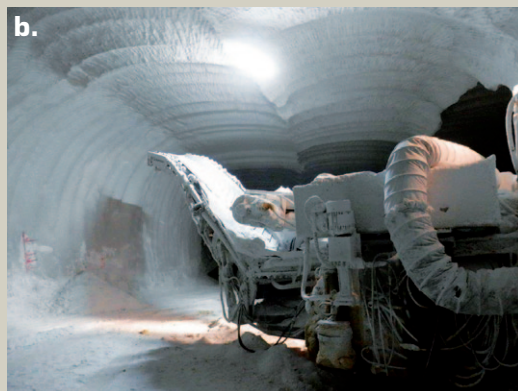
PETRALIA a. Fresa in produzione sui fronti b. Nastri che convogliano il materiale estratto c. Aree per la movimentazione materiali in sotterraneo d. Linea di produzione del sale alimentare e. Nastri della linea di produzione f. Nastri di trasporto dei pallets finiti g. Campione di salgemma
