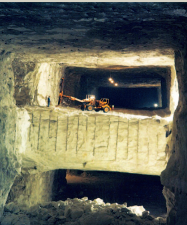
Figura 5 - Coltivazione camere e pilastri nella miniera di Realmonte
