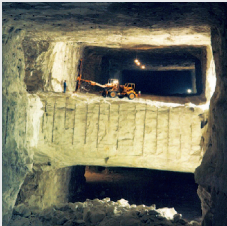
Coltivazione camere e pilastri nella miniera di Realmonte
